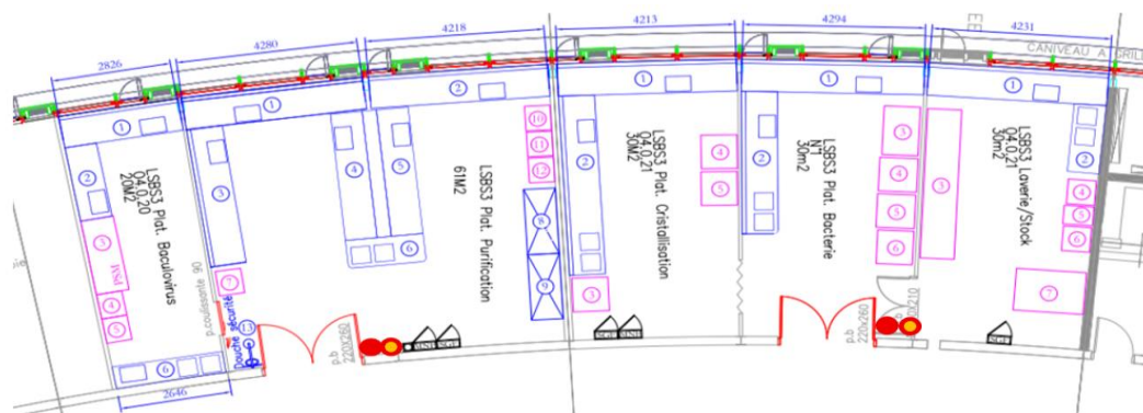
Figure 4 : Laboratoires _ Position des extincteurs
